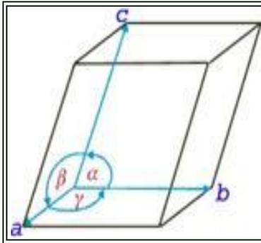
Del apilamiento de estas redes se obtienen las **redes tridimensionales**. Existen 14 tipos diferentes de redes tridimensionales (**redes de Bravais**) que se agrupan en 7 sistemas cristalinos diferentes. Cada sistema cristalino viene caracterizado por unos determinados valores de las traslaciones y de los ángulos que forman de su celda unidad:
